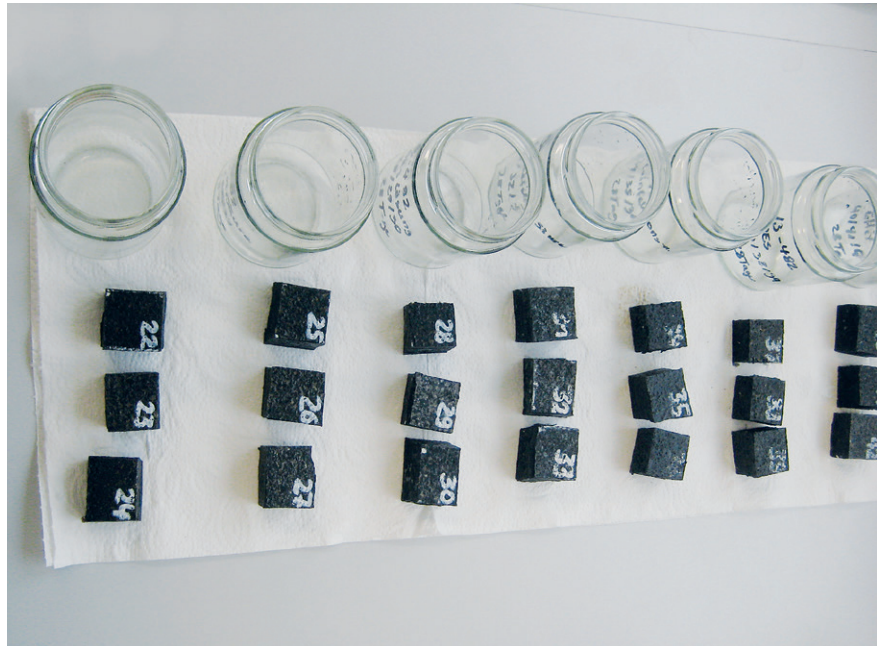
Bild 9: Prüfmuster nach Säurebeständigkeitstest
